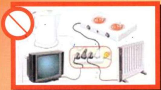
не допускать включение нескольких электрических приборов большой мощности в одну розетку
